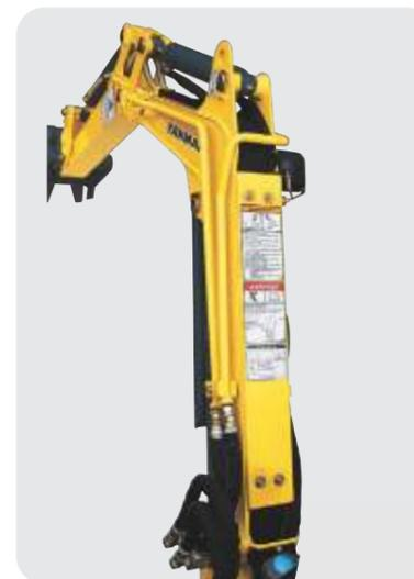
\*P.T.O. (Power take-off). Sistema de acionamento da bomba hidráulica para operação dos acessórios.
